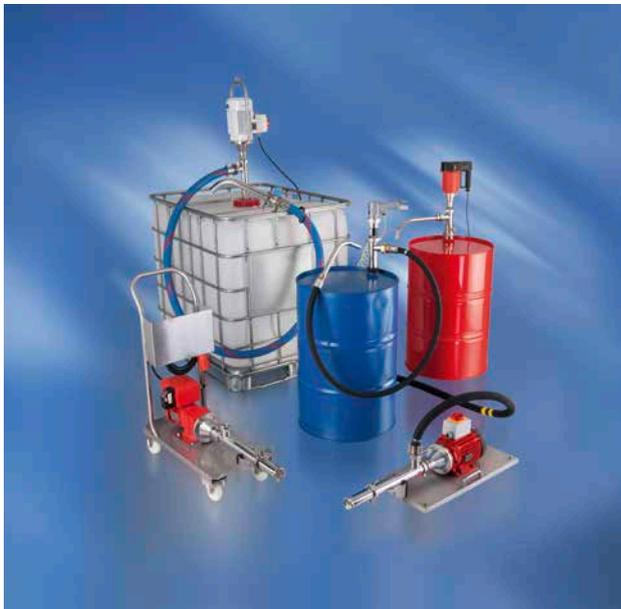
FLUX偏心蜗杆传动泵适用于泵送稀薄流体和高粘度流体。容积式泵可在恒定压力下运行，湍流度低，且可实现平缓的无脉动式操作。550系列泵浦用于工业环境，而经过特殊配置的560系列泵浦则适用于制药业、食品和化妆品等行业。所有泵浦均可移动或固定使用，仅由几个部件构成，易拆卸。
