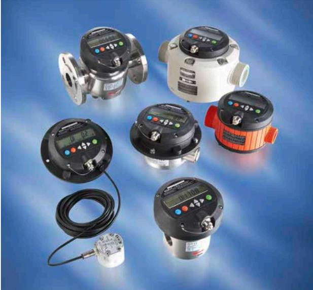
按圆盘原理 (FMC)、椭圆形转子 (FMO) 或涡轮原理 (FMT) 制造的FLUX流量计可为各行各业提供最佳解决方案。流量计可用于FLUX桶泵或固定在管道，具体取决于产品型号和整机尺寸。适用于FMC和FMO灌装与计量流程的数字式显示器FLUXTRONIC®几乎可用于所有液体，能达到最高精度和最大安全性。在自动模式下，还可传输控制信号，从而调节不同工艺流程。
