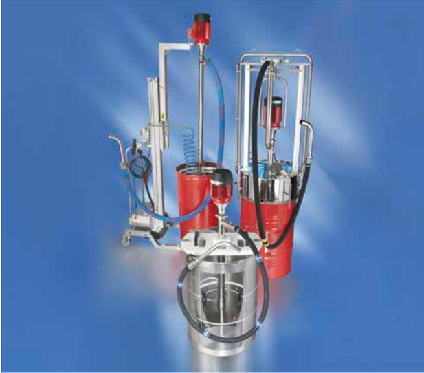
VISCOFLUX桶泵排空装置专为排空带盖桶内的高粘度介质而设计。利用FLUX偏心蜗杆传动泵连续且格外谨慎地抽出介质。所有装置几乎均可通过桶泵实现完整排空，容器内的残留物含量低于1%（对于装有内联装置的桶泵，该值小于2%）。
