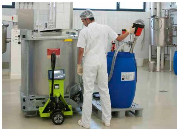
F 560 GS用于卫生行业，可泵送原料，例如将奶油泵送至混料桶内。
