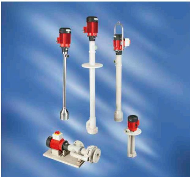
FLUX离心式浸入泵可满足较高流速、连续运行或特殊浸入长度等使用要求，尤其适用于从小型容器至高4.1米的储罐的中泵送或循环有腐蚀性和研磨的介质，此类液下泵有不同材质可供选择，具体取决于化工及热工性能要求。另外，还可提供无机封式液下泵和卧式液下泵。FLUX离心式液下泵具有个性化配置，并根据具体案例按照相关技术要求制造。
